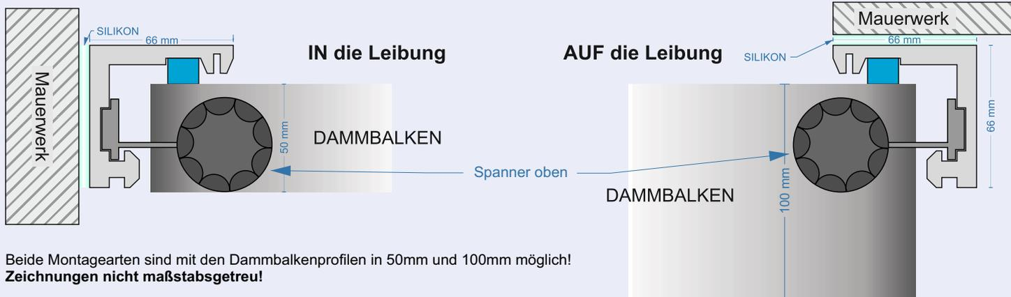
Beide Montagearten sind mit den Dammbalkenprofilen in 50mm und 100mm möglich!
