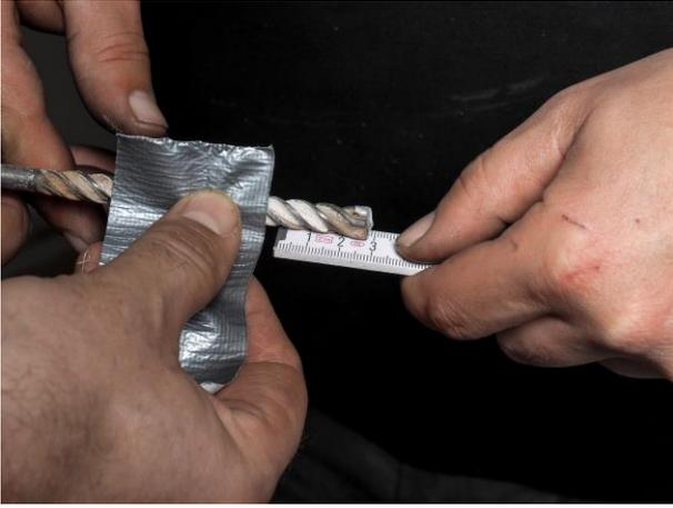
5. Den Bohrer 3cm von der Bohrspitze entfernt abkleben – tiefer sollte nicht gebohrt werden.
